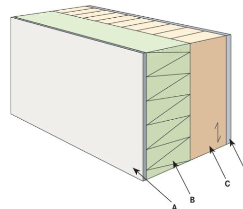
Mur extérieur avec façade bois et ventilation arrière
