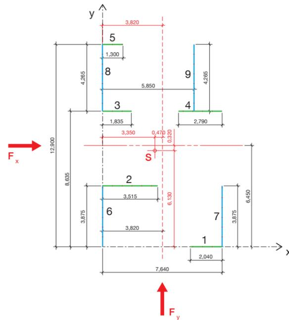
Système de renforcement avec position et longueur des murs de contreventement.
